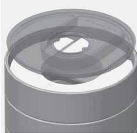
Abb. 3.27 Einlegen der Guss-Abdeckung
