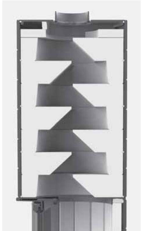
Abb. 3.13 Aufbau des Aufsatzes
