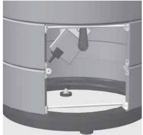
Abb. 3.2 Stellfüße unter dem Geräteboden, abgenommene Abdeckung
