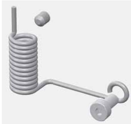
Abb. 3.6 Türfeder, Madenschraube und Spanschraube
