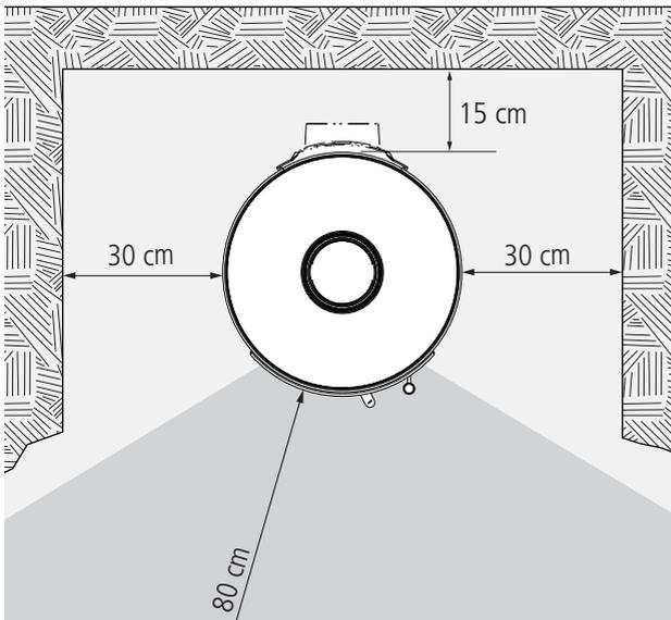
Der Speicherofen muss nach hinten und zur Seite Mindestabstände zu temperaturempfindlichen oder brennbaren Baustoffen oder Bauteile mit brennbaren Bestandteilen einhalten.
