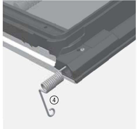
Abb. 3.8 Türfeder einsetzen
