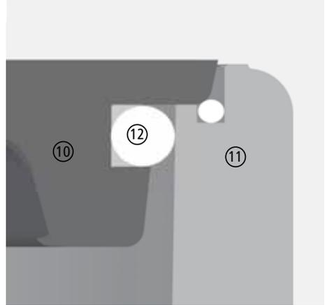
Abb. 3.28 Dichtnut im obersten Gussring, Dichtprofil der Abdeckung
