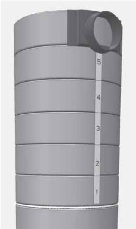
Abb. 3.14 Kennzeichnung des Aufsatzes mit hinterem Abgang
