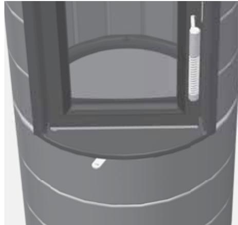
Abb. 4.6 Verbrennungsluft-Schieber, links, ganz geschlossen
