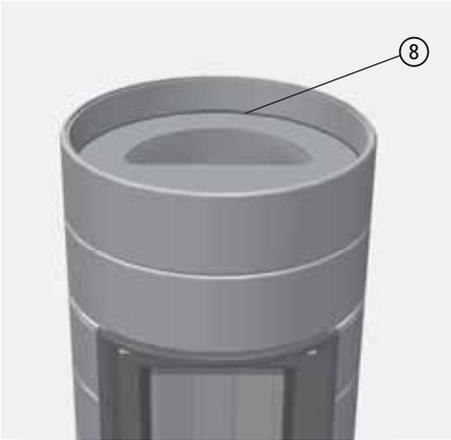
Abb. 3.24 umlaufende Kittfuge über zweiten Speichereinlage
