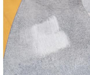
Entfernen Sie regelmäßig losen Staub mit einem trockenen Tuch. Wenn der Umriss/Fleck nur noch schwer sichtbar ist, können Sie den Stein mit der Körnung P220 nachbehandeln
