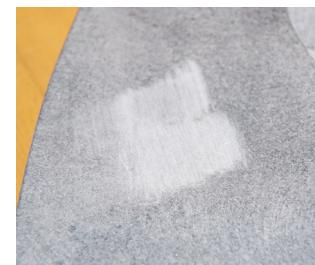
Ta efter hand bort det lösa slipdammet med en torr trasa. När repan/fläcken knappat syns längre är det dags att efterbehandla stenen med vätslippappret med kornstorlek P220.
